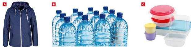
Figura 2 Polimeri sintetici Alcuni dei principali utilizzi del nylon (A), del PET (B) e del polipropilene (C).
